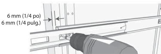
**5.** Attacher la glissière au cadre frontal (ou à la paroi) de l'armoire avec une vis à bois de 1/2 po, en prenant garde que l'avant de la glissière se trouve à 6 mm (1/4 po) de l'extérieur de l'armoire. Voir l'illustration.
