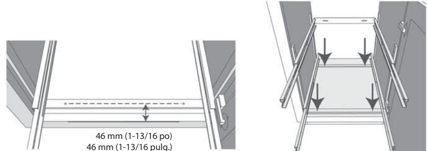
**6.** Attacher les ferrures de support en U avec des vis à bois de 3/4 po au fond de l'armoire en plaçant les trous de montage à une distance de 46 mm de l'extérieur de l'armoire. Voir l'illustration.
